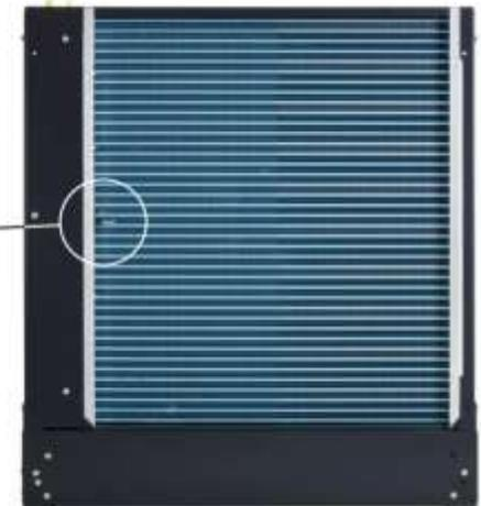
Трубчатый медный теплообменник с алюминиевым ребрением, покрытым специальной краской для лучшего стекания конденсата и снижения сопротивления при прохождении воздуха
